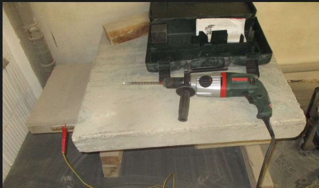
Bohrungen mittels Bohrmaschine mit Abschaltautomatik
