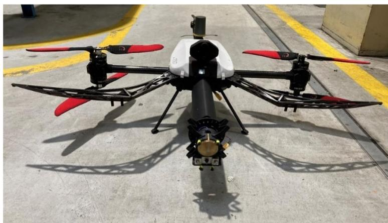
**Abb 6:** Drohnensystem mit Impact-Echo-Sensoreinheit
