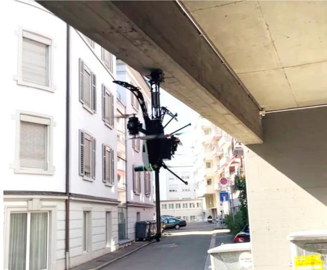
**Abb 3:** Drohne fliegt in vertikaler Lage und inspiziert ein Gebäude.
