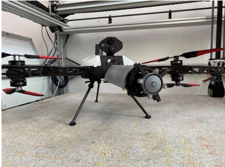
**Abb 8:** Drohnenmesssystem mit Potentialfeld-Sensoreinheit
