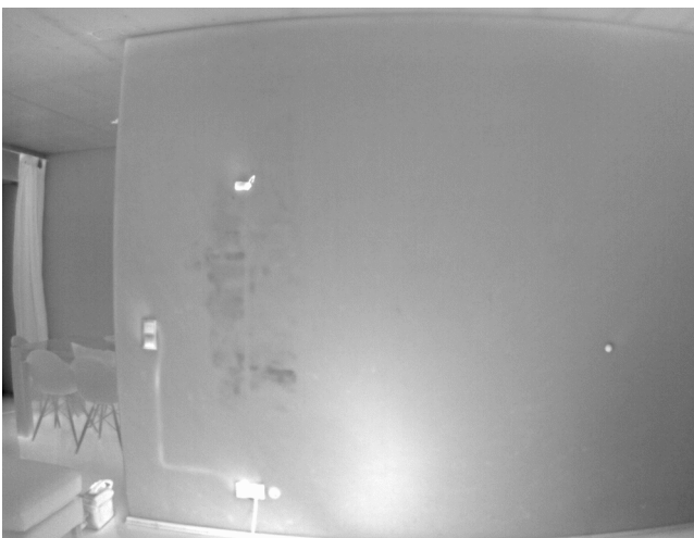
Abb 5: Wie nötig die Puls-Phasen-Thermografie hier gewesen ist, zeigt der Vergleich zu einem Einzelbild am Ende der Aufheizphase: Die Esse ist allenfalls nur schwach und nicht in ihrer vollen Ausdehnung nachweisbar.
