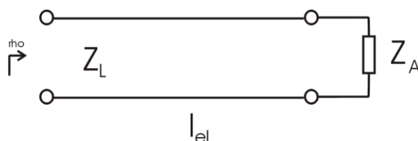
Abb. 3. Modell einer elektrischen Zweidrahtleitung
